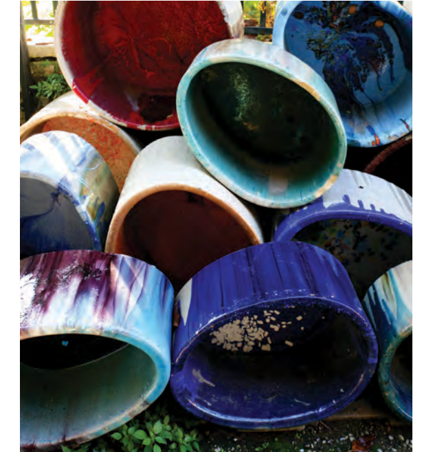
Crucibles used for glass fusion with traces of color / Crogioli utilizzati per la cottura del vetro con tracce di colore
